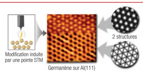
Image de microscopie champ proche en résolution atomique montrant le basculement de structure.
