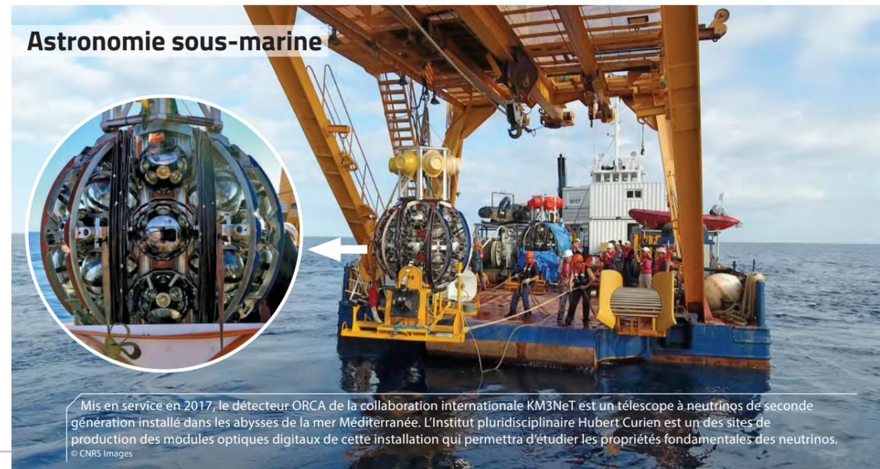
Mis en service en 2017, le détecteur ORCA de la collaboration internationale KM3NeT est un télescope à neutrinos de seconde génération installé dans les abysses de la mer Méditerranée. L'Institut pluridisciplinaire Hubert Curien est un des sites de production des modules optiques digitaux de cette installation qui permettra d'étudier les propriétés fondamentales des neutrinos.
