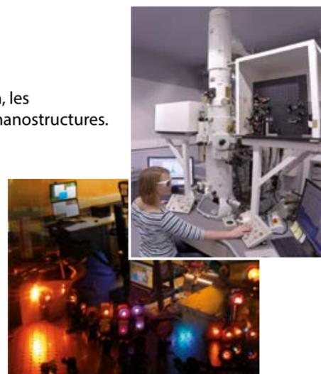
↑ En haut : microscope électronique en transmission avec ultra-haute résolution temporelle.
