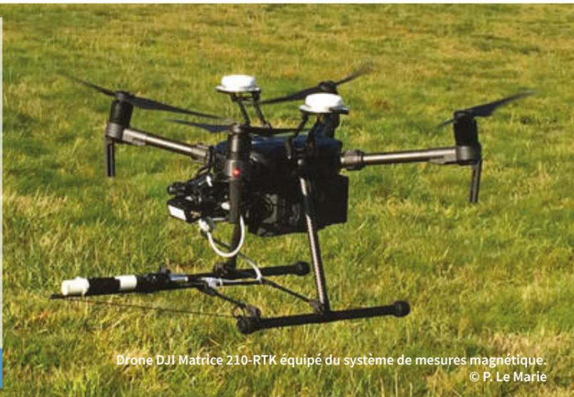
Drone DJI Matrice 210-RTK équipé du système de mesures magnétique. © P. Le Marie
