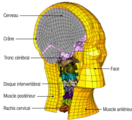
Illustration du modèle éléments finis du système « tête et cou ».
