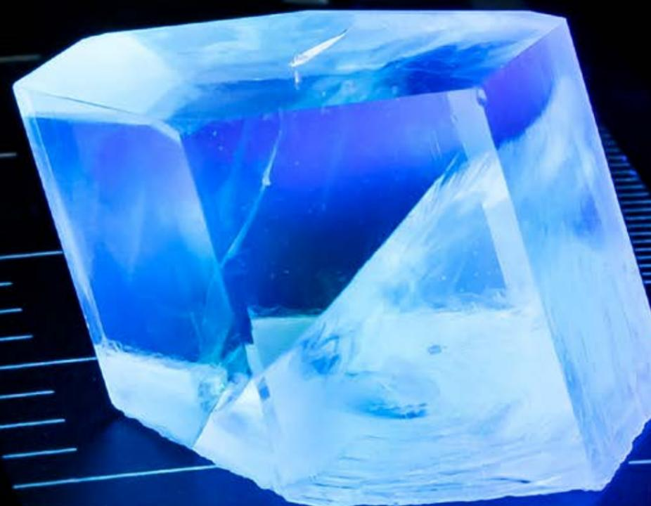
Monocristaux luminescents centimétriques sous irradiation ultraviolet capables de détecter les neutrons.
