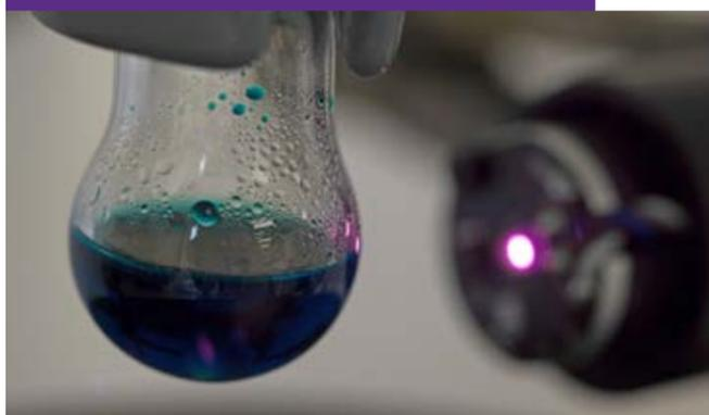
Vue du montage expérimental. Les réactions sont réalisées dans un tube en verre fermé et éclairé par une LED infrarouge (810 nm). Le système est protégé de tout rayonnement lumineux extérieur. La réaction est effectuée à température ambiante.
